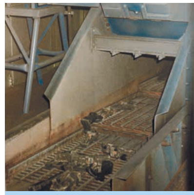
Rost zur Trennung von Guss und Formsand Louvre deck shakeout for separating cast iron and moulding sand
