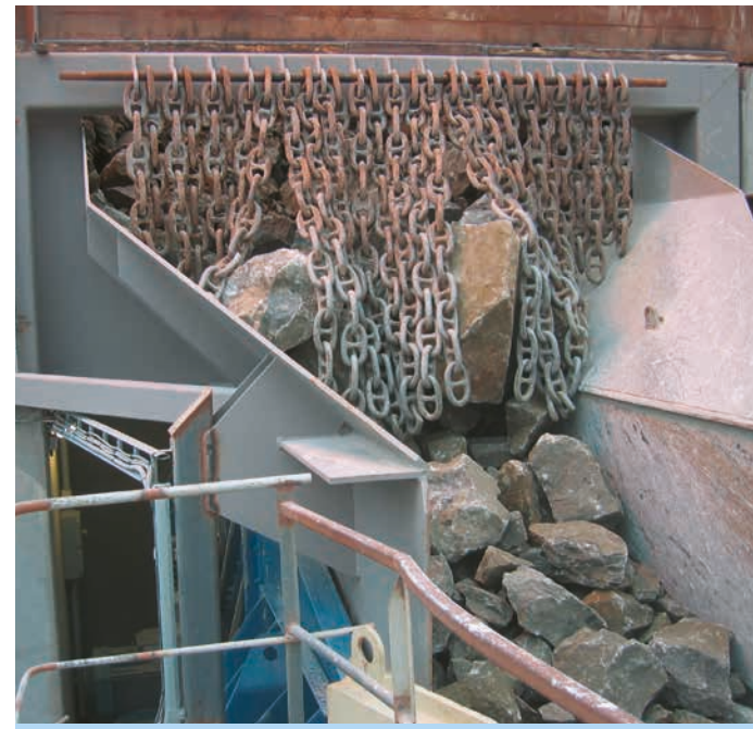
Vorabscheider mit Unwuchterreger für Hartgestein Scalper with unbalanced exciter drive for hard stone
