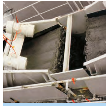
Entwässerungssieb mit Unwuchtmotoren in der Kiesindustrie Dewatering screen with unbalanced motors for sand and gravel
