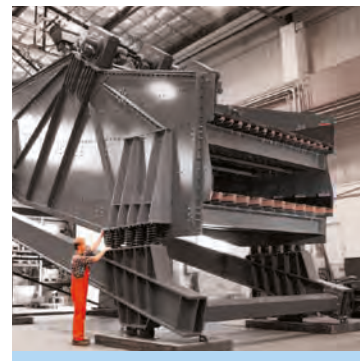
Doppeldeck-Bananensieb für sehr große Aufgaberaten Double-deck Banana screen for very high capacities
