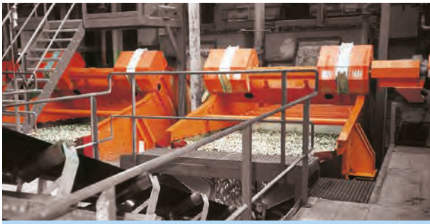
Eindeck-Linearschwingsieb in der Sand- und Kiesindustrie Single-deck vibratory screen for sand and gravel
