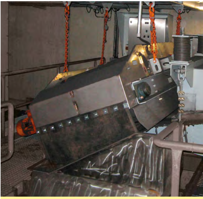
Überbandmagnetscheider Magnetic overband separator
