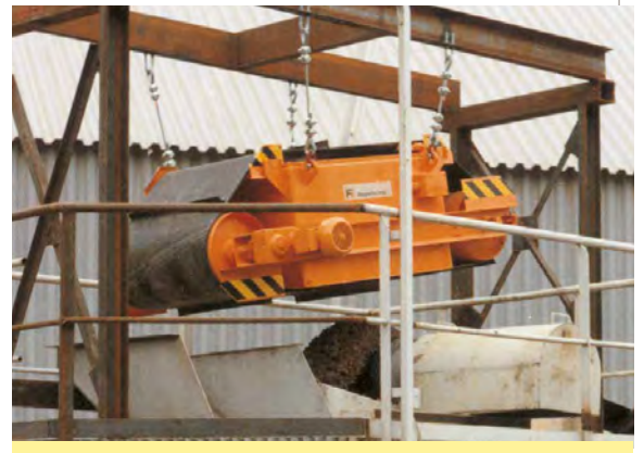
Überbandmagnetscheider Magnetic overband separator
