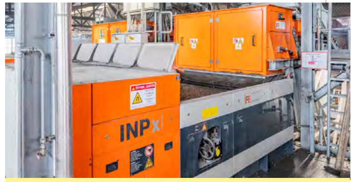
Wirbelstromscheider zur Aufbereitung von Müllverbrennungsschlacke Eddy current separator for processing waste-incineration slag
