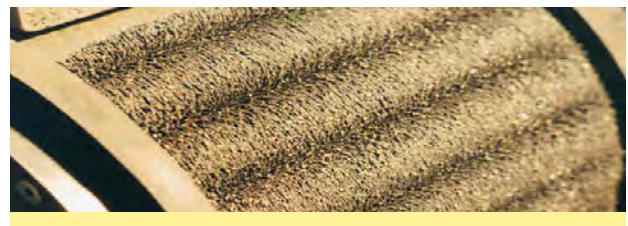
Hochintensitätstrommelscheider High intensity drum separator
