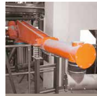
Vibrationsförderrohr mit Unwuchtmotoren Tubular feeder with unbalanced motors
