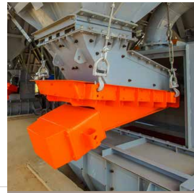
Elektromagnetische Vibrationsförderrinnen zur exakten Dosierung von Erz und Koks Electromagnetic feeders for the precise dosing of ore and coke
