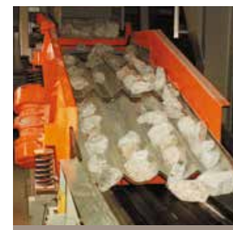
Spezialförderrinne in optischer Sortieranlage Special vibrating feeder in optical sorting plant
