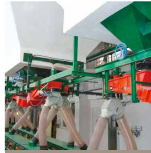
Elektromagnetische Dosierinnen für Zuschlagstoffe Dosing feeders for alloy material
