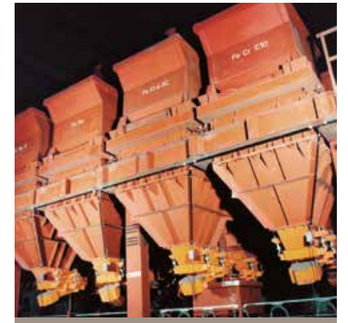
Dosierinnen in einem Edelstahlwerk Dosing feeders in a stainless steel plant
