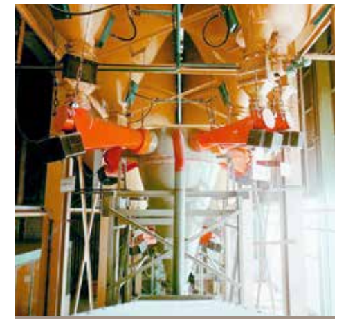
Elektromagnetische Förderrohre in Wiegeanlage Electromagnetic tube feeders in weighing plant feeder for high capacities
