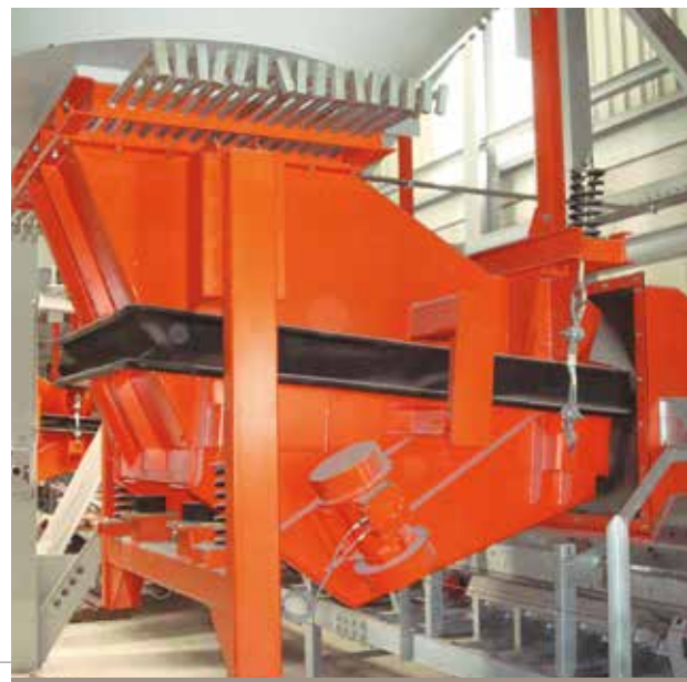
Unwuchtrinnen in staubdichter Ausführung Dustproof unbalanced motor feeders
